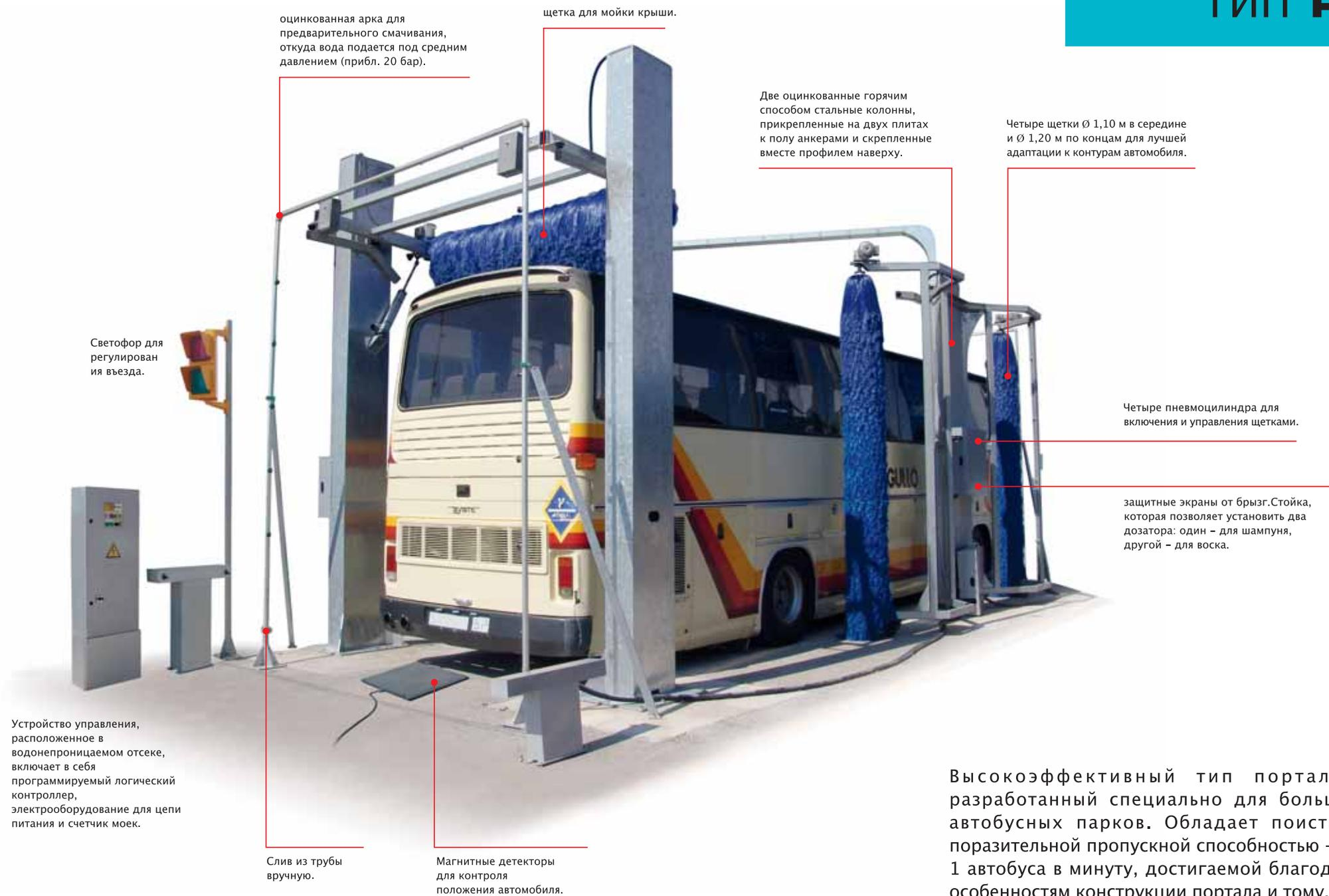
оцинкованная арка для предварительного смачивания, откуда вода подается под средним давлением (прибл. 20 бар).
