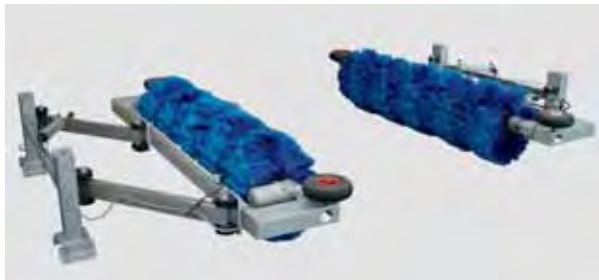
Мод. 4046500 НИЖНИЕ БОКОВЫЕ ГОРИЗОНТАЛЬНЫЕ ЩЕТКИ Требуют как минимум +3,2м длины конвейера. Две щетки длиной 2,0м, приводимые в действие моторредукторами мощностью 0,55 Kw. Приспосабливаются к ширине машины, осуществляя идеальную мойку колес, нижних боковых поверхностей и порогов.
