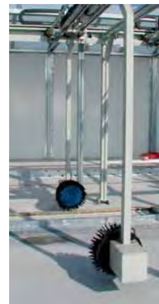
Мод. 4020500 Мойка колесных дисков, устанавливаемая на основном модуле 100 машин/час.
