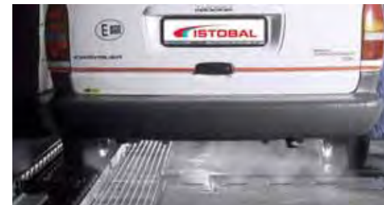
Мод. 4020600 МОЙКА ДНИЩА 10/15 бар 160 л/м Состоит из системы труб с форсунками и расположена под полом. Необходим электронасос Мод. 4004700 или 4026400.
